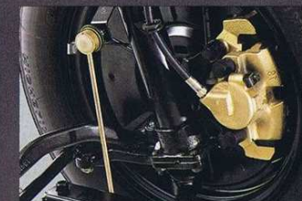
Bild 5, Sonderausstattung: BMW Leichtmetallräder (7) verringern die ungefederten Massen des Fahrzeugs – das Ansprechverhalten des Feder-Dämpfersystems wird feinfühligere und die Straßenlage noch einmal verbessert. Aufwendige Schalldämmungsmaßnahmen (5, 6) mit den je nach Einsatzbereich und -zweck bestgeeigneten Materialien – wie z. B. hochgefüllter PUR-Schaum, Schwertschicht-Material und Vlies – sichern ein sehr niedriges Geräuschniveau. Da auch bei der Fahrzeugakustik mit modernsten Methoden geforscht und konstruiert wird, bietet der 524td selbst auf diesem Gebiet besonderen Komfort.
